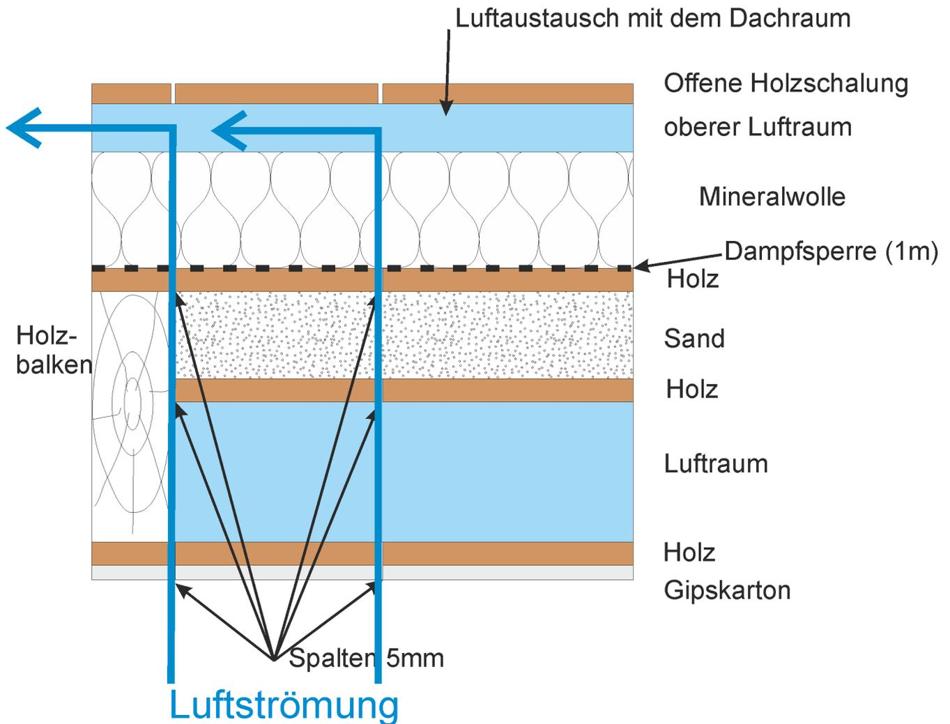
Abbildung 22. Konstruktion Geschoßdecke
