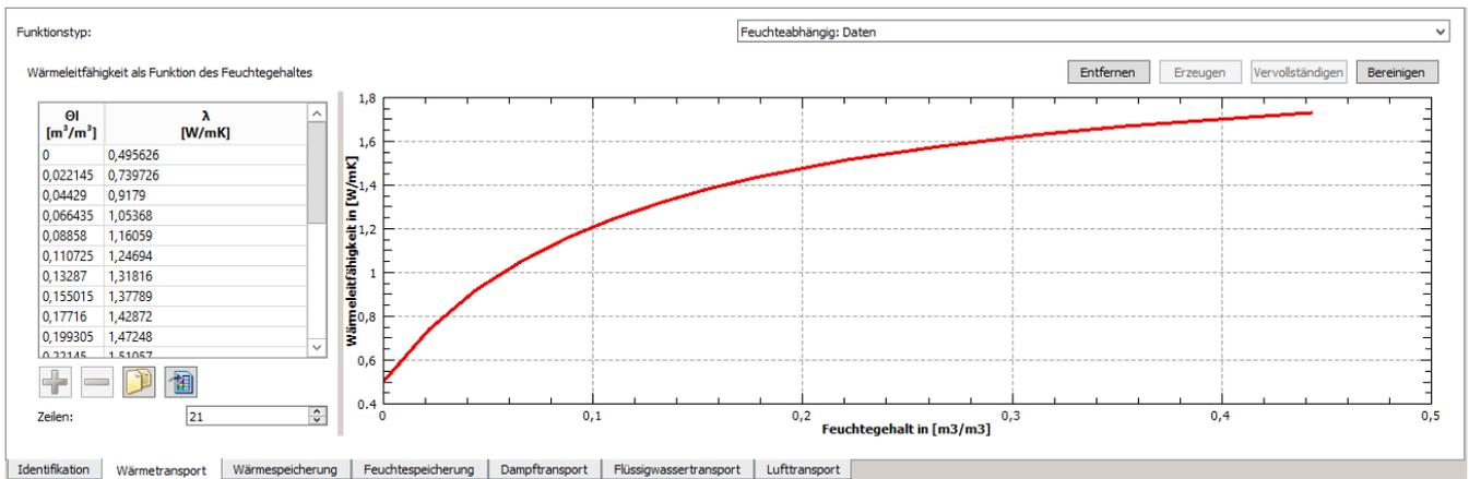
Abbildung 13. Feuchteabhängige Wärmeleitung mit hinterlegten Daten
