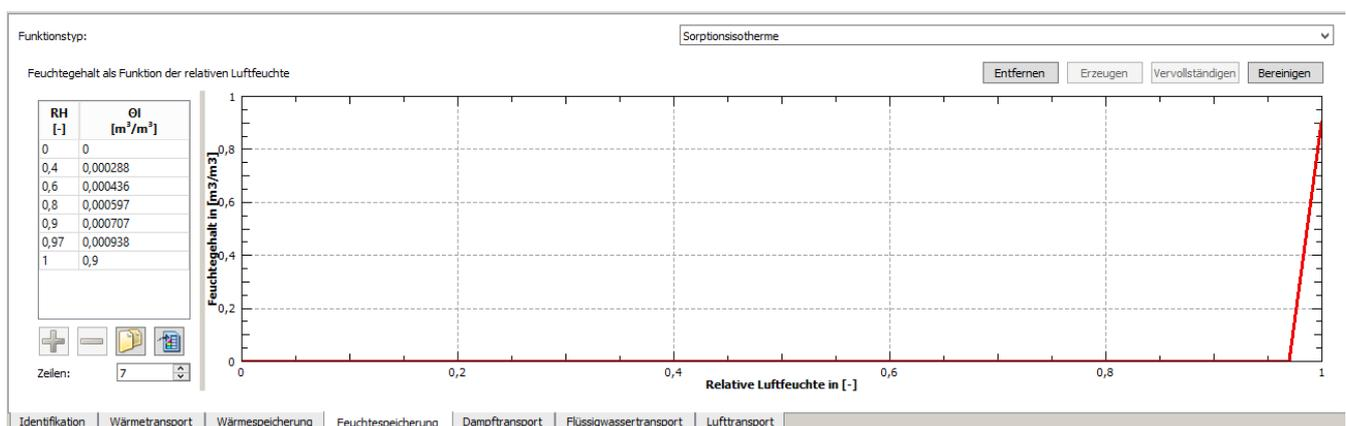
Abbildung 16. Feuchtespeicherfunktion mit Sorptionisotherme
