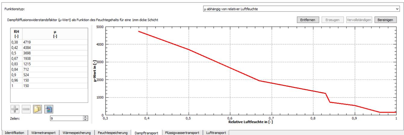
Abbildung 18. Fenster Dampftransport -  $\mu(RH)$ -Funktion
